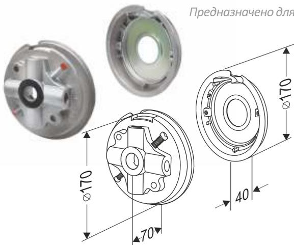
Предназначено для пружины с внутренним диаметром 152 мм с левой навивкой.
